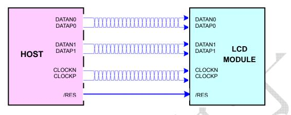
Figure 3-1 DSI System Interface
